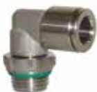
Rácores automáticos en acero inoxidable AISI 316, tubos de \varnothing 4 a 12 mm, roscas de M5 a 1/2".
